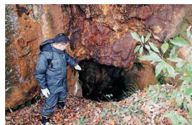
地下に浸透した雨水と鉱石が触れることによって重金属を含む酸性水が発生することがあります。休廃止となった鉱山でも、周辺の湧水のモニタリングが欠かせません。
